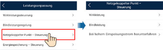
Abbildung 7-11 Netzgekoppelter Punkt – Steuerung
