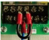
Abbildung 3-3 (Entsprechende Position mit einem kurzen Draht anschließen)
