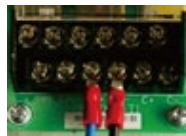
Abbildung 3-5 (Den kurzen Draht entfernen)
