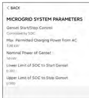
Abbildung 8-42 MicroGrid System Parameters
